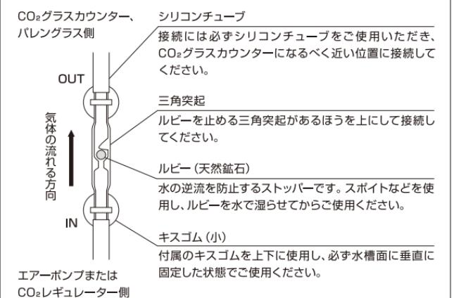
※接続方向に注意し、必ず垂直に設置してご使用ください。
